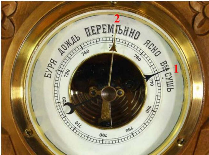
Барометр. 1 — измерительная стрелка; 2 — стрелка для запоминания значений (устанавливается вручную)
