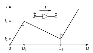
**А.** Рассмотрим туннельный диод, параметры которого равны  $I_1 = 4I_2 = 4i$ ,  $U_2 = 4U_1 = 4u$ , при этом значения i и u считаются известными. Этот диод подключили к идеальному источнику с напряжением  $U_0 = 6u$ , последовательно с переменным резистором, сопротивление которого может меняться в широких пределах (см. рисунок, представленный ниже). При каких значениях сопротивлениях резистора значение тока в цепи определяется однозначно?
