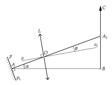
На упрощённой схеме, представленной на рисунке, собирающая линза L символизирует объектив. Главная оптическая ось объектива  $oo_1$  отклонена на угол  $\varphi$  от линии зрения  $AA_1$ , составляющей угол  $\alpha$  с горизонталью. Фотографируемый предмет изображается отрезком BC,  $pp_1$  — плоскость, в которой располагается светочувствительная матрица фотоаппарата (или плёнка, если речь идёт о плёночной камере).
