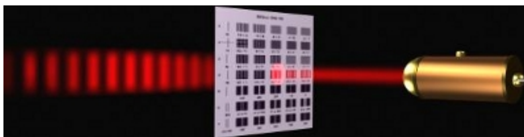
Рис. 25. Дифракция лазерного луча на решётке
