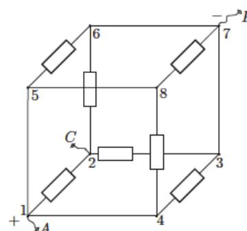
1) Найдите силу тока  $I_{AB}$  и сопротивление куба  $R_{AB}$  между клеммами  $A$  и  $B$ .
