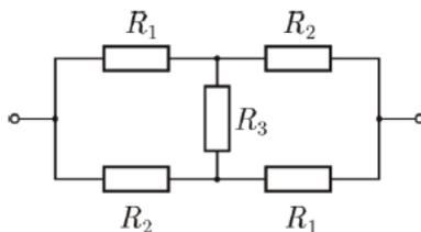
$$\boxed{R = \frac{2R_1R_2 + R_1R_3 + R_2R_3}{R_1 + R_2 + 2R_3} \approx 14,4 \text{ Ом}}$$
