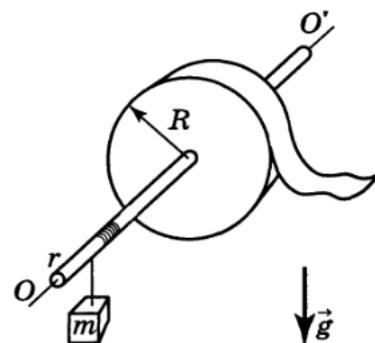
ЗАДАЧА 4. (МФТИ, 2008) Дифференциальный ворот представляет собой два скреплённых соосных цилиндра радиусами  $R = 10$  см и  $r = 8$  см, на которые намотан трос. Трос перекинут через подвижный блок, а его концы закреплены на цилиндрах (см. рисунок). При вращении рукоятки  $OA$  длиной  $L = 20$  см вокруг неподвижной горизонтальной оси цилиндров  $O$  трос наматывается на больший цилиндр и сматывается с меньшего, а груз, подвешенный к подвижному блоку, поднимается.
