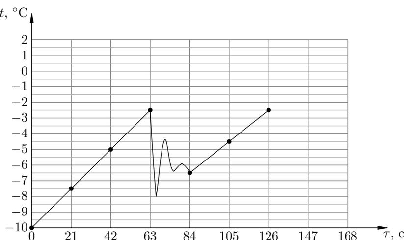
Мощность печи 125 Вт, масса добавленного снега 125 г
