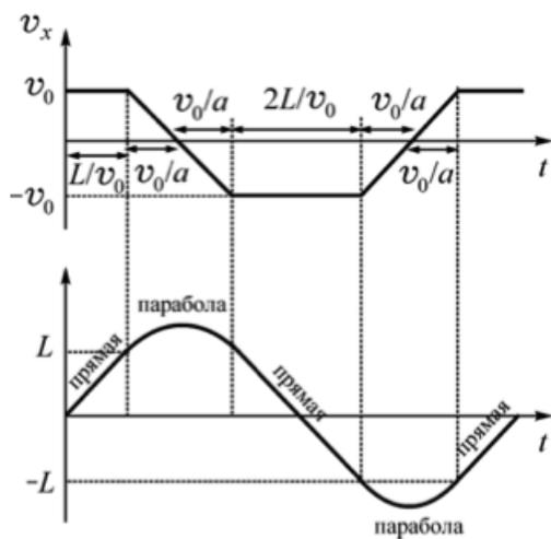
Период колебаний частицы  $T = 4 \left( \frac{L}{v_0} + \frac{mv_0}{qE} \right)$ ;  $T_{\min} = 8\sqrt{\frac{mL}{qE}}$  при  $v_0 = \sqrt{\frac{qEL}{m}}$ .
