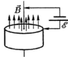
При вращении диска между осью вращения и боковой поверхностью возникает разность потенциалов, которую можно измерить с помощью неподвижного вольтметра (рис. слева). Если же к оси вращения и боковой поверхности подсоединить батарейку, то магнит начнёт быстро вращаться, превратившись в электродвигатель. Точно так же, если быстро вращать вал обычного электромотора, то он превращается в генератор, и наоборот, если на электрический генератор подать напряжение, то он превращается в электромотор.
