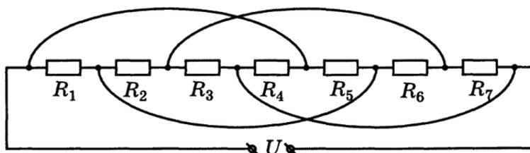
$$I_{\min} = \frac{U}{R_7} = 7,6 \text{ мА}; \quad I_{\max} = I_5 = \frac{U}{R_5} = 10,64 \text{ мА}$$
