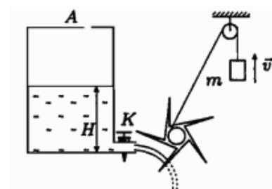
1) Определите коэффициент полезного действия модели водяной турбины, принимая высоту столба воды в бочке  $H = 0,2$  м, скорость груза  $v_1 = 2$  см/с.
