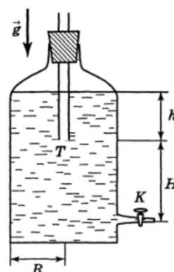
ЗАДАЧА 5. (Всеросс., 2004, финал, 9) Любопытный ученик 9 класса соорудил на даче модель водяной турбины (рис.). Вода из широкой бочки вытекала через небольшое отверстие площадью  $S = 1$  см<sup>2</sup> у дна и попадала на лопасти турбины. С помощью нити, намотанной на тонкий вал турбины и перекинутой через блок, устройство могло поднимать вверх груз массой  $m = 100$  г с некоторой скоростью.
