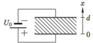
где  $d$  — расстояние между пластинами конденсатора. Конденсатор подключён к батарее с напряжением  $U_0$  (рис.). Найдите:
