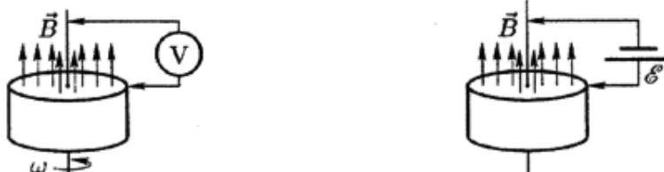
При вращении диска между осью вращения и боковой поверхностью возникает разность потенциалов, которую можно измерить с помощью неподвижного вольтметра (рис. слева). Если же к оси вращения и боковой поверхности подсоединить батарейку, то магнит начнёт быстро вращаться, превратившись в электродвигатель. Точно так же, если быстро вращать вал обычного электромотора, то он превращается в генератор, и наоборот, если на электрический генератор подать напряжение, то он превращается в электромотор.
