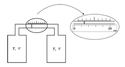
Когда температуры газов в сосудах равны  $T_0 = 300$  K, поршень располагается посередине трубки. При незначительных изменениях температур в сосудах поршень смещается вдоль шкалы, нанесённой рядом. Перерисовав в тетрадь, проградуируйте эту шкалу (оцифруйте её
