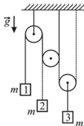
$$\boxed{\text{Модули ускорений грузов одинаковы и равны } g/3}$$
