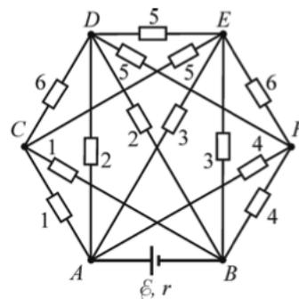
$$P = 6 \text{ Вт}; P^{AC} = P^{CB} = 1,44 \text{ Вт}, P^{AD} = P^{DB} = 0,36 \text{ Вт}, P^{DE} = P^{EF} = 0,72 \text{ Вт}, P^{AE} = P^{BE} = 0,48 \text{ Вт}, P^{CD} = P^{CE} = P^{DF} = P^{DE} = P^{FE} = 0$$
