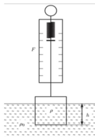
По результатам измерений определите плотность кубика и плотность жидкости.
