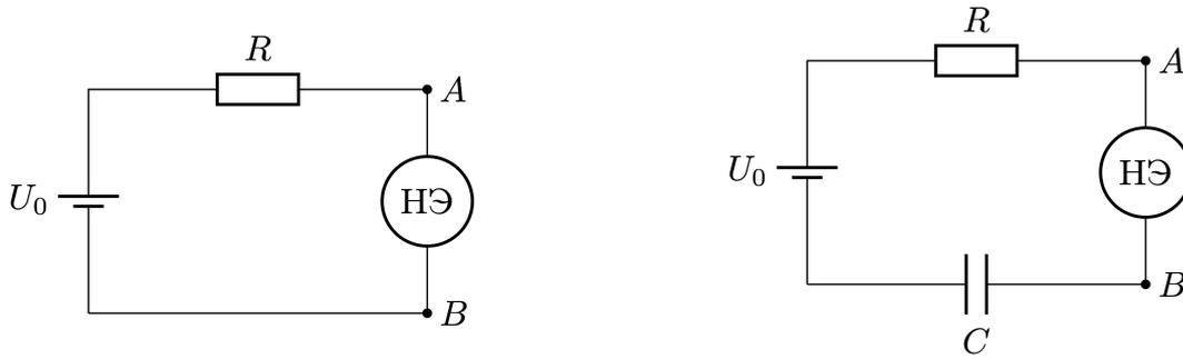
**Часть 2.** Электрическая цепь, схема которой приведена на рисунке, состоит из источника постоянного напряжения  $U_0$  с пренебрежимо малым внутренним сопротивлением, резистора с сопротивлением  $R$ , конденсатора ёмкостью  $C = 10$  мФ и нелинейного элемента, для которого  $U_1 = 2$  В.
