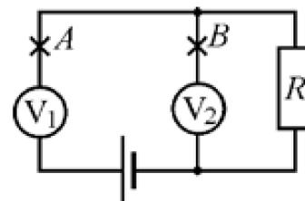
1. Какое напряжение покажет вольтметр  $V_2$ , если разорвать цепь в точке  $A$ ? Ответ выразите в вольтах, округлите до целого числа.
