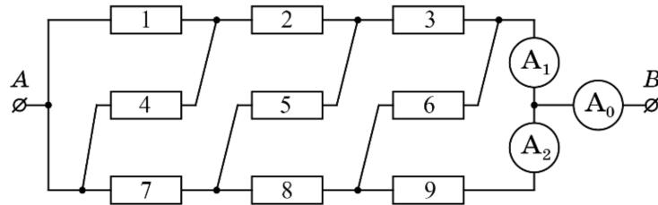
Через амперметр  $A_0$  протекает ток силой  $I_0 = 9$  мА. Определите показания амперметров  $A_1$  и  $A_2$ .
