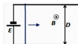
В первой серии опытов рельсы поддерживались в сверхпроводящем состоянии, а суммарное сопротивление контура, по которому протекал ток (состоящее из сопротивления перемычки, внутреннего сопротивления источника и сопротивления контактов), было примерно постоянно и равно  $R_0 \approx 0,8$  Ом. При этом оказалось, что перемычка разгоняется до 95% от максимальной возможной (для этой установки), пройдя путь  $s_0 = 80$  м.
