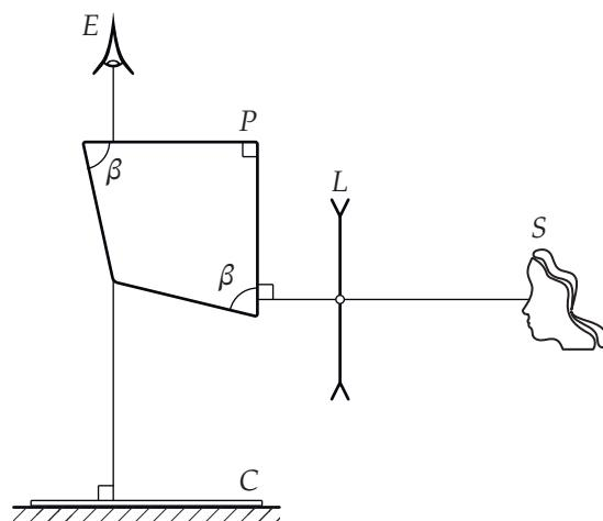
В устройстве используется рассеивающая линза  $L$ , а также призма  $P$  из стекла с показателем преломления  $n = 3/2$ , имеющая в сечении четырёхугольник с одним прямым углом и двумя одинаковыми острыми углами, равными  $\beta$ . Рисовальщик смотрит вертикально вниз на лист бумаги  $C$  (на котором рисует).
