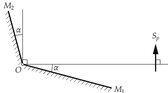
**B.** На рисунке, приведённом ниже, изображена оптическая схема *камеры-люциды* — устройства, которое раньше применялось для перерисовывания предметов, людей, пейзажей с натуры. Размеры на схеме непропорционально изменены. Глаз рисовальщика обозначен буквой  $E$ , а перерисовываемый объект — буквой  $S$ .
