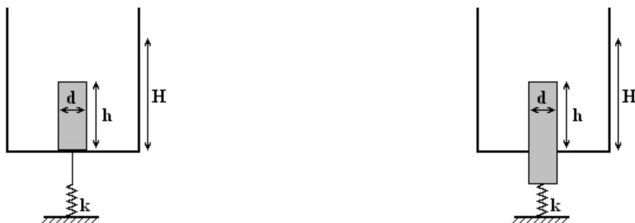
В бак налили воду до уровня  $H = 30$  см (вода не показана на рисунке). В узкое отверстие вода не просачивается.
