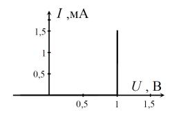
$r=rac{\mathcal{E}_0}{I_0}=1500$  Ом;  $R_x=1500$  Ом; диод:  $r_x^+=rac{\mathcal{E}_0 U_0}{I_0(\mathcal{E}_0-U_0)}=3000$  м,  $r_x^-=\infty$
